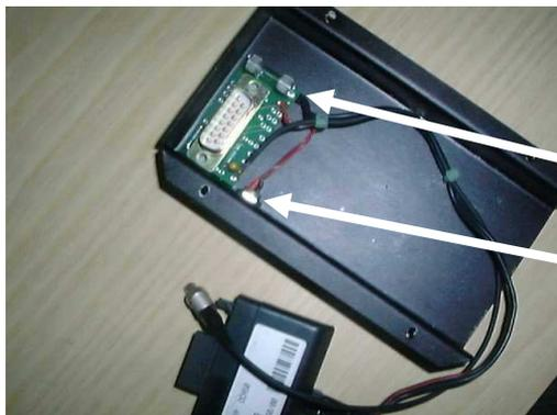
Beispiel der adapterseitigen Verdrahtung mit einer Herausführung der Spannung auf den seitwärts angebrachten Konnektor.
