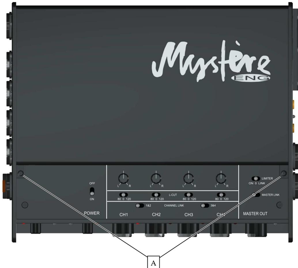
Der Geräte-Deckel ist mit 2 Schrauben auf das Kontroll-Pannel gesichert. Der 9-polige D-SUB-Konnektor für Funk-Mikrofon, der sich auf dem Deckel unter dem RF Mikrofon-Adapter befindet (sofern die Option gekauft worden ist) hat folgende Buchsen-Belegung:
